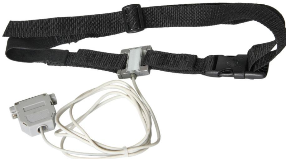
Рис. 8. Датчик для пневмографии.
